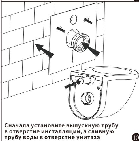
Сначала установите выпускную трубу в отверстие установки, а сливную трубу в отверстие унитаза 10
