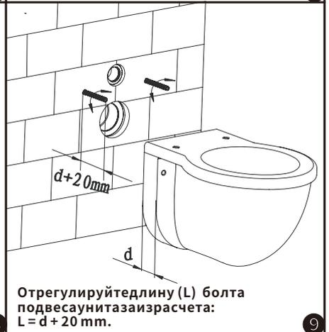
Отрегулируйте длину (L) болта подвески унитаза из расчета: L = d + 20 mm. 9
