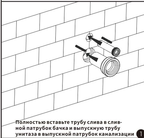
Полностью вставьте трубу слива в сливной патрубке бачка и выпускную трубу унитаза в выпускной патрубке канализации 1
