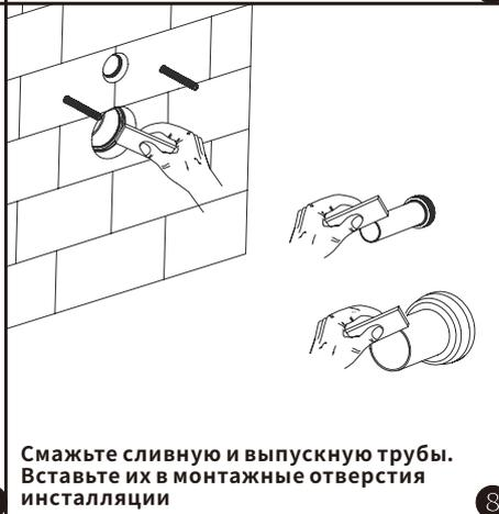
Смажьте сливную и выпускную трубы. Вставьте их в монтажные отверстия установки 8
