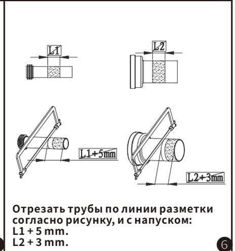
Отрезать трубы по линии разметки согласно рисунку, и с напуском: L1 + 5 mm.
