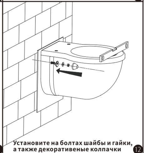
Установите на болтах шайбы и гайки, а также декоративные колпачки 12
