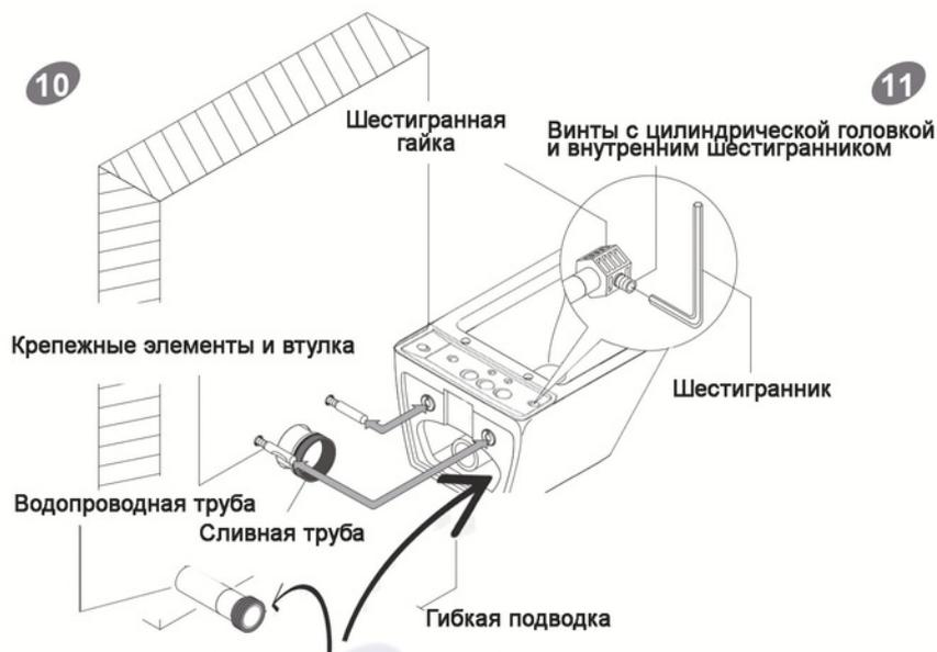
При установке необходимо использовать гибкую подводку (входит в комплект) для подсоединения унитаза к водопроводной системе с помощью переходника с 3/4 на 1/2 (входит в комплект).
