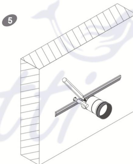
Вставьте сливную трубу во внутреннее отверстие с отводом в стене и начертите разметку карандашом как показано на рисунке
