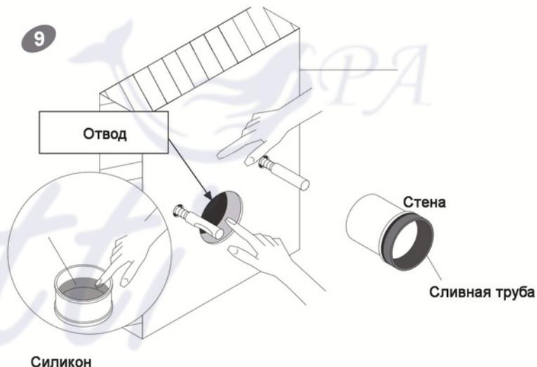
Смажьте внутреннее отверстие с отводом в стене силиконом и вставьте в него сливную трубу
