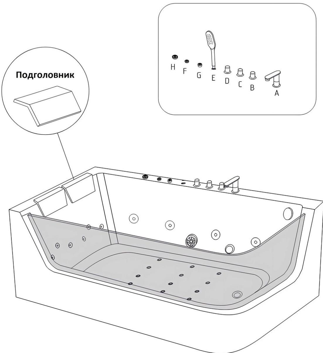
В - регулировка холодной воды
